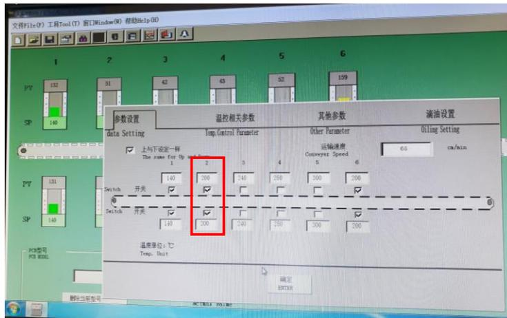
11.- Cuando todas las zonas hayan alcanzado la temperatura ideal y estén en color verde, hay que presionar " COOLING". **NOTA: SOLO SI NO FUE PRESIONADO EN EL PASO 3.**
